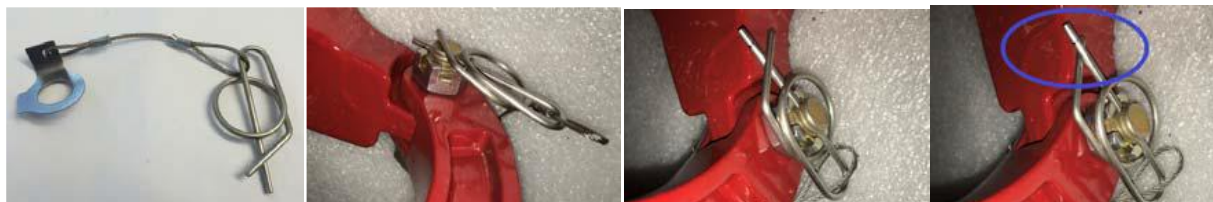
(1) Kit; (2) Instalado não travado; (3) Travamento “mola”; (4) Travamento mecânico Anel de travamento como alternativa a contra-pino 3
