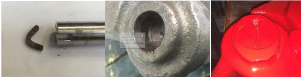
(1) Pino e barra; (2) Furo com as cavidades, (3) Barra instalada 3
